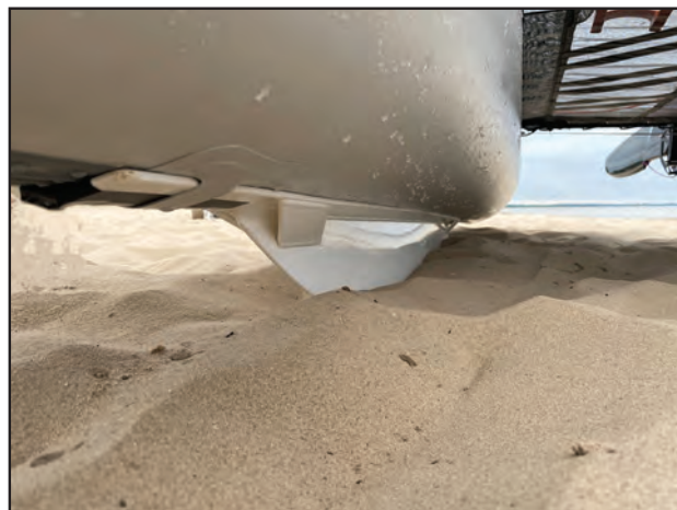
Les quillons - et plus particulièrement les équerres de renfort - mériteraient une optimisation hydrodynamique.
