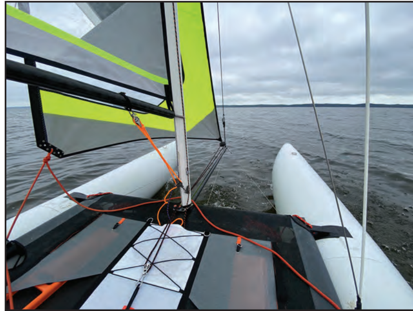
Les assises sur le trampoline et les boudins sont très confortables. Les points de tire excentrés du génois interdisent de caper serré.
