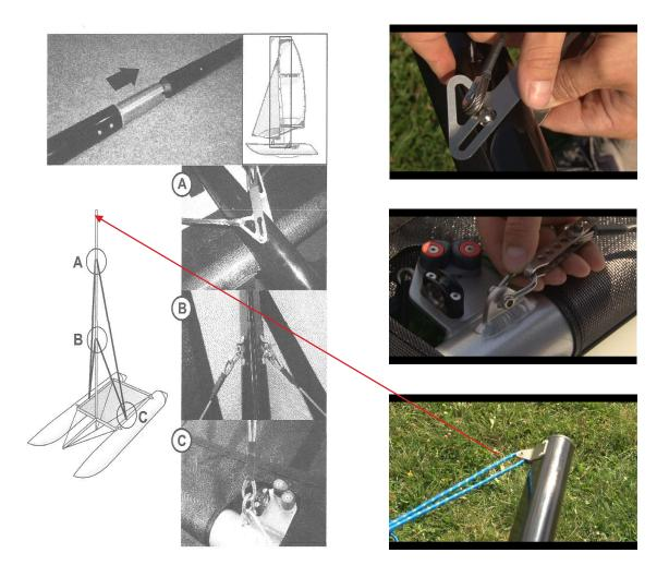
Das Seil mit dem sie das Hauptsegel hissen, müssen Sie an der Mastspitze durch die Rolle führen und die beiden Enden <u>leicht</u> zusammenknoten. Der Knoten dient dazu, dass das Seil nicht selbständig von der Rolle rutscht. Sollte dies der Fall sein, müssen Sie den Mast nochmals demontieren und das Seil erneut einziehen.
