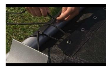
Befestigen Sie die Kielfinne an der Unterseite der nicht aufgeblasenen Schwimmer. Schieben Sie die Kielfinne in die dafür vorgesehenen Laschen.
