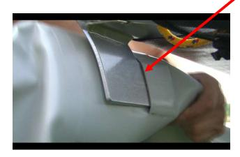
Jetzt können sie die Schwimmer mit der Pumpe aufblasen. Bitte beachten sie den maximalen Betriebsdruck von 0.25 Bar.
