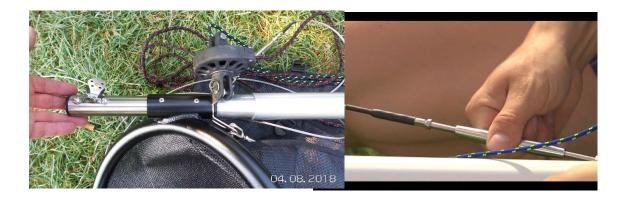
Das Grossegel ausrollen und dann am Zugseil befestigen. Das Zugseil läuft von der Rolle oben am Mast zum Grossegel. Legen Sie das Segel in die Kerbe im Mast und ziehen Sie das Segel in die Höhe. Dann fixieren sie das Zugseil (Grossschot) an der Klampe unten am Mast.
