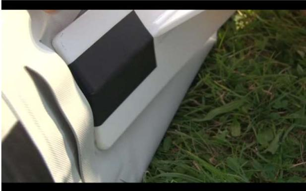
Befestigen Sie den Rahmen bei nicht aufgeblasenem Schwimmer. Befestigen Sie den Rahmen, indem sie die Fahnen in die dafür vorgesehenen Taschen an den Schwimmern schieben.
