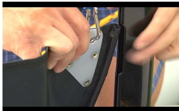
Montieren Sie die Segel-Latte mit dem Scharnier auf der Mastseite (bis Bj.13) und straffen das Segel durch.
