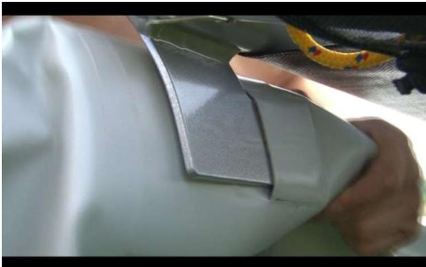
Jetzt können sie die Schwimmer mit der Pumpe aufblasen. Bitte beachten sie den maximalen Betriebsdruck von 0.25 Bar.
